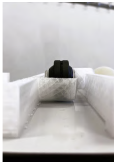
Maquette, rotule comme solution à l'hyperstatisme
