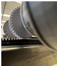
Maquette, mise en évidence de l'hyperstatisme au niveau de la crémaillère
